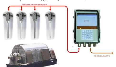
В системе используются цифровые датчики температуры разработки ЖШСИ.661.100, разработанные в ФИЦ ИВТ.
