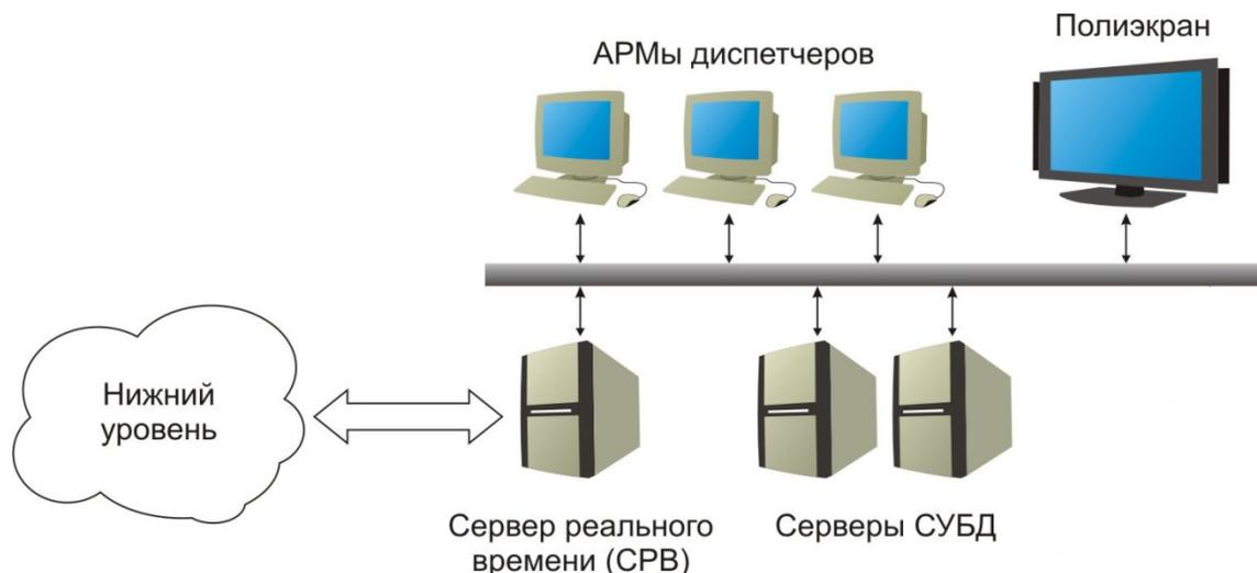
Центральным ядром системы является SCADA разработки ФИЦ ИВТ. Основное достоинство этого ядра – чрезвычайная надежность и живучесть, отточенные многолетней практикой внедрений и эксплуатации. Эти качества достигаются применением специализированной сетевой операционной системы реального времени QNX. Эта операционная среда среди прочих достоинств обладает стойкостью к кибератакам.
